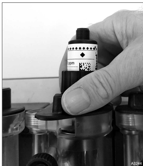
Kuva 20: Anturin asennus anturimoduuliin
